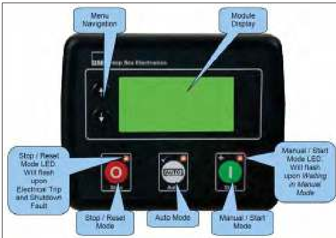
Fig. E3.9 Illustration of DSE4520 Module / Controller
