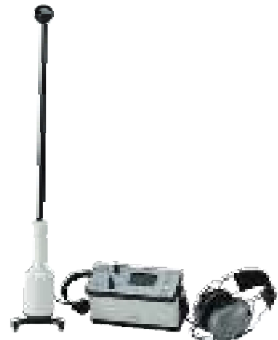
Figure 237: Digiphone type shock wave receiver (Sébaréseaux)
